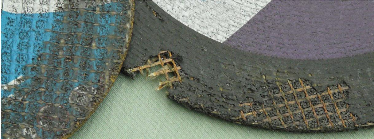
Mit der zweiten Trennscheibe wurden einige Schruppversuche gefahren, aber auch diese zersprangen mehr oder weniger.
