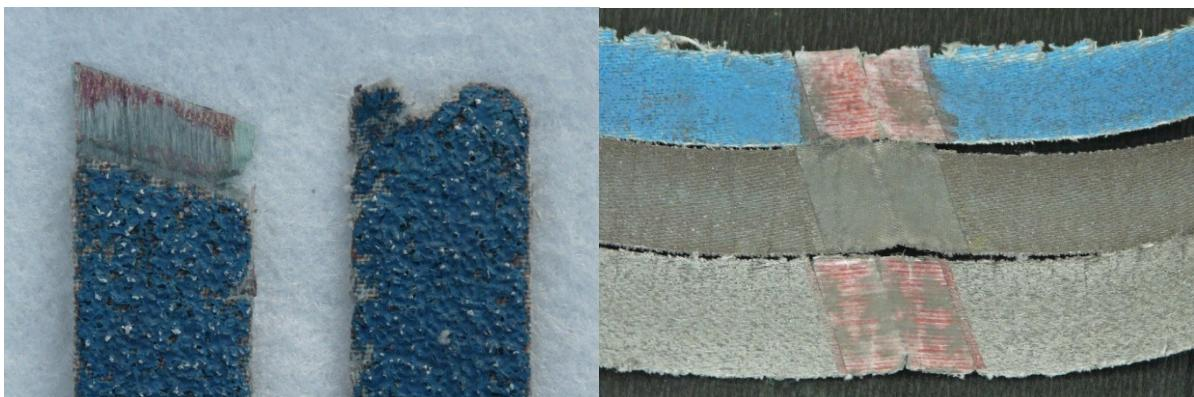
Das zweite Band (blaue Rückseite, dunkelgrüne Arbeitsfläche) verfügte über eine zu dünne Unterlage, was es in Querrichtung einfach zu weich machte. Dies hatte zur Konsequenz, dass die Ränder dieses Bandes ausfranzten. Dadurch war die
